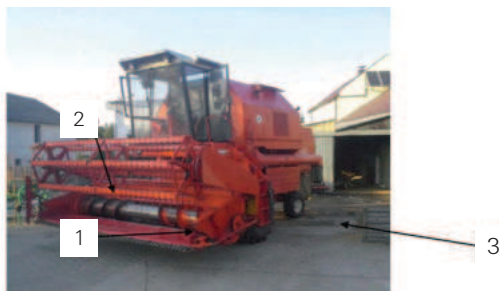
Rys. 1. Kombajn zbożowy przygotowany do zbioru rzepaku: 1 - stół, 2 - kosa boczna, 3 - napęd kosy od targańca
