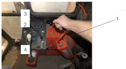
Rys. 2. Widok prawej strony wnętrza kabiny operatora: 1 - korba do zmiany szczeliny omlotowej; 2 - korba do zmiany prędkości obrotowej bębna; 3 - wskaźnik prędkości obrotowej bębna; 4 - lewerek zmiany biegów
